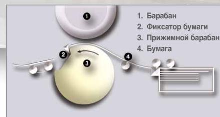
Уникальная система с двумя барабанами и механизмом фиксации бумаги, гарантирующая безупречное качество изображений и приводеки.
